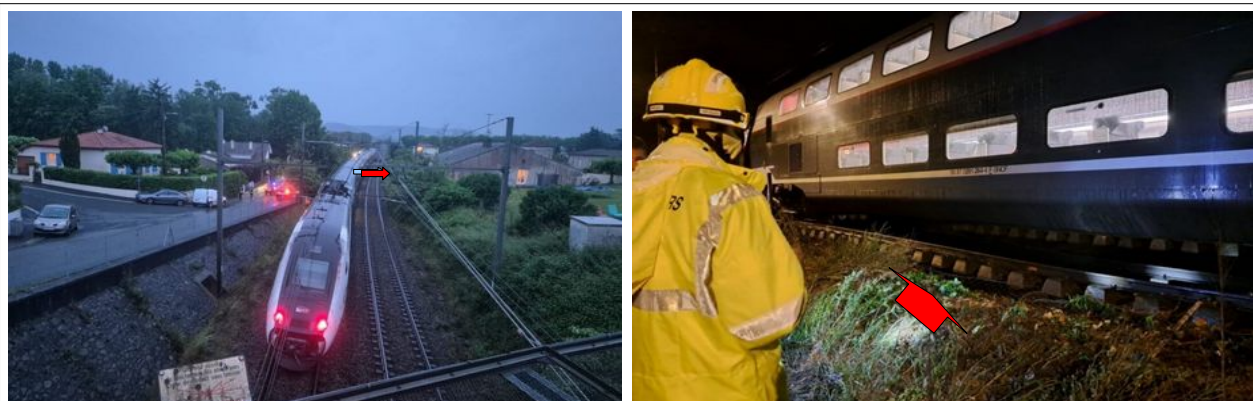
TGV arrêté sur voie 1 et localisation de la brèche (source : Le républicain) – légendes BEA-TT
