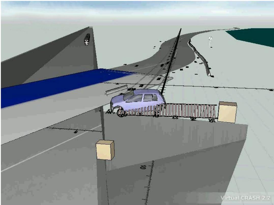
**Schéma 2 : Capture d'écran d'une séquence vidéo de la simulation de la collision et de la chute du parapet**
