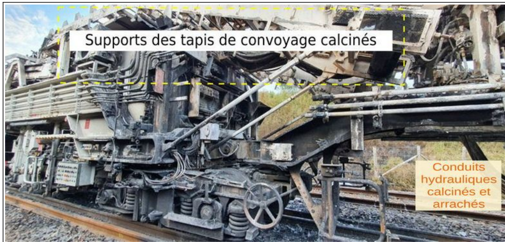
Figure 33 : Conduits hydrauliques calcinés entre les véhicules MW2 et STM (BEA-TT)
