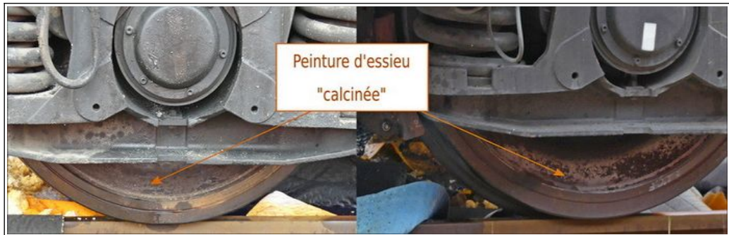
Figure 37 : Peinture roues SVB800 – état avec peinture incendiée (BEA-TT)
