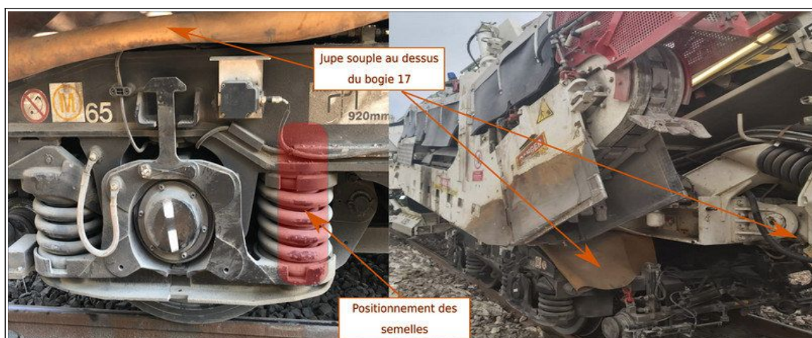
Figure 21 : Bogie 17 avec bâche (jupe) souple repliée débordant des essieux L33 et L34 en position acheminement (source BEA-TT)
