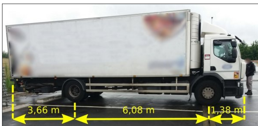
Figure 17 : Vue du PL impliqué et dimensions Photo et légende BEA-TT
