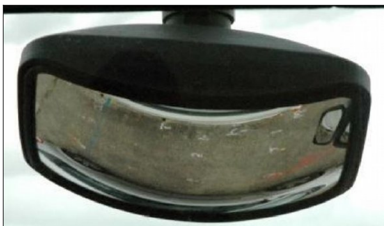
Figure 49 : Vision du conducteur, par le rétroviseur d'accostage, d'une voiture grise adjacente à la cabine
