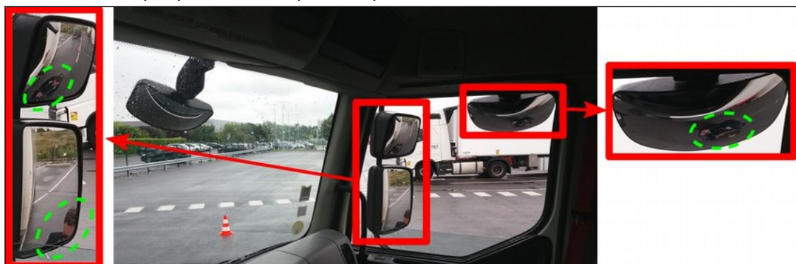
Figure 35 : Simulation des circonstances de l'accident : Vue des rétroviseurs, un piéton étant placé à côté de la roue avant droite Photo et légende BEA-TT
