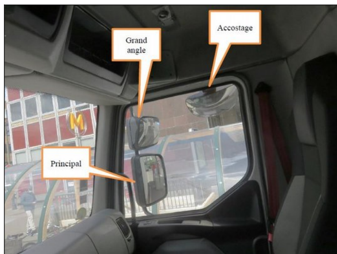
Figure 25 : Vue des rétroviseurs du côté droit depuis le poste de conduite Photo et légende expert judiciaire
