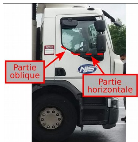
Figure 32 : Vue du côté droit de la cabine du PL Photo et légende BEA-TT
