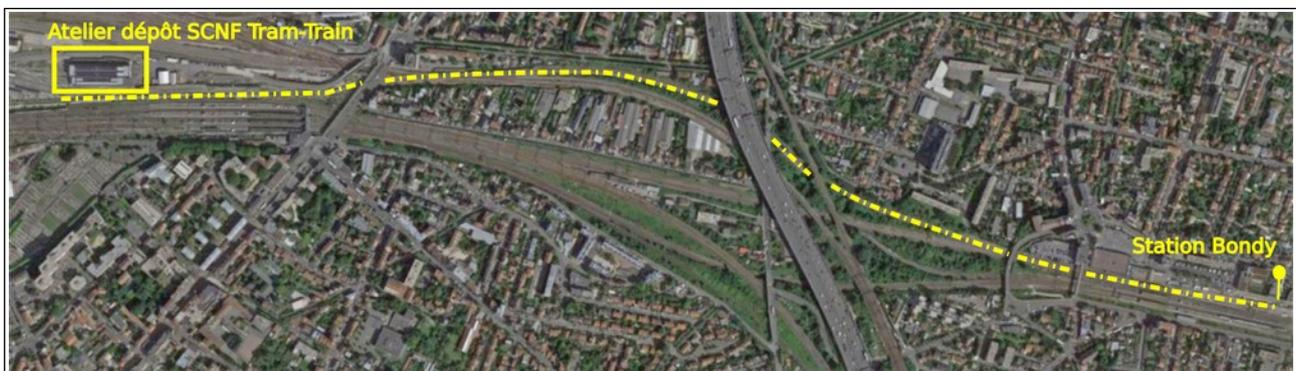
**Figure 8 - Liaison RFN entre le dépôt-atelier de la ligne T4 et la station terminus Bondy**
