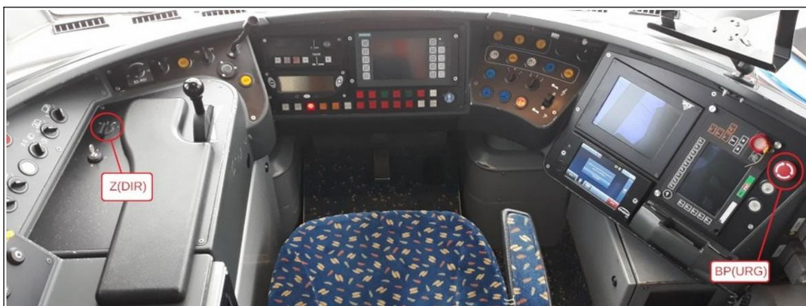
Figure 17 - Schéma du pupitre de conduite de l'Avanto sur la ligne T4 (photo SNCF)
