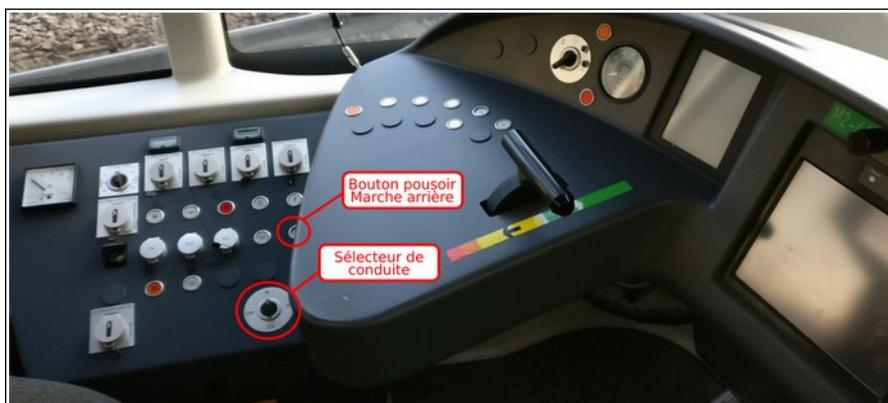
**Figure 32 - Côté gauche du pupitre d'une rame Citadis X02 de la ligne parisienne T2**
