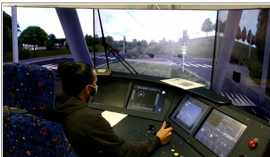
**Figure 19 - Simulateur en fonctionnement avec l'opérateur tractionnant au manipulateur**
