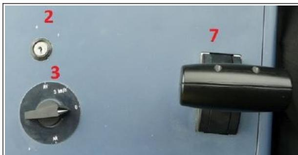
**Figure 33 - Partie gauche du tableau de bord du CAF nantais : sélecteur de sens de marche en n° 3** (source SEMITAN<sup>7</sup>)
