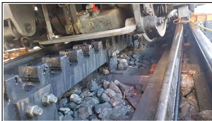
Figure 37 : Inclinaison de l'automotrice A46, vue sous la caisse depuis l'amont
