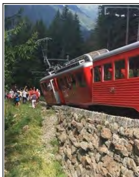
Figure 2 : Train déraillé vu de l'amont
