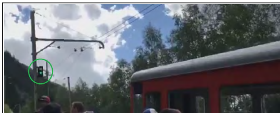
Figure 29 : Photo du feu vert "voie directe" après l'accident
