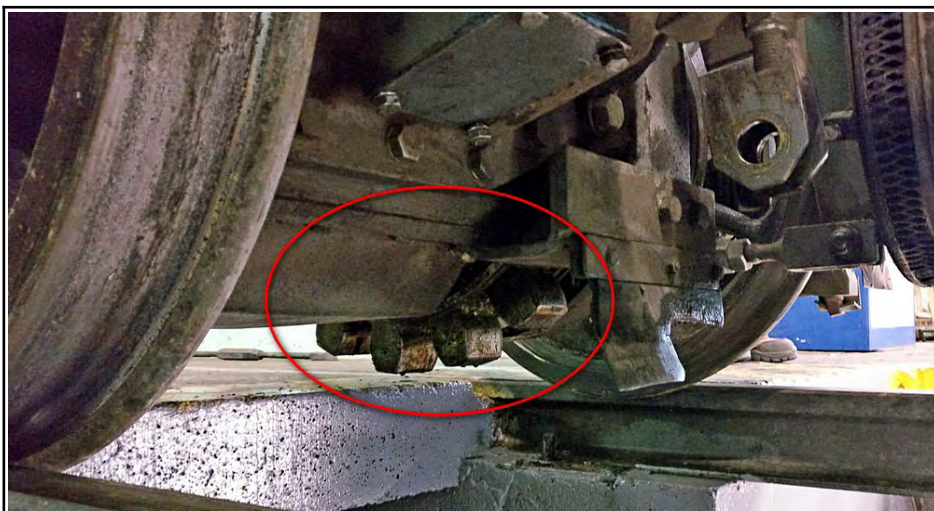
Figure 10 : Roue dentée sous une automotrice du Montenvers
