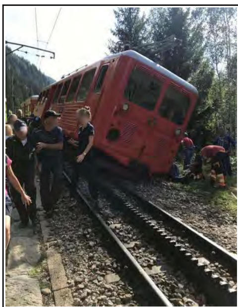
Figure 1 : Train déraillé vu de l'aval
