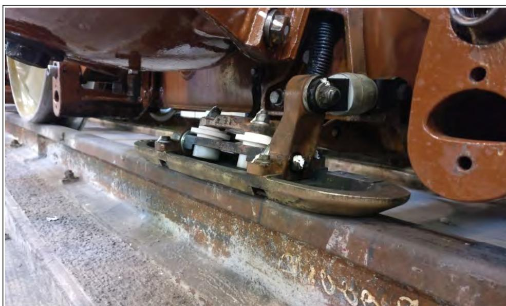
Figure 16 : frotteur négatif ou de masse neuf installé sur un bogie
