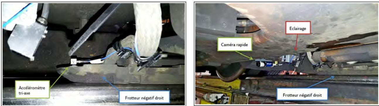
**Figure 39 : instrumentation des frotteurs négatifs
