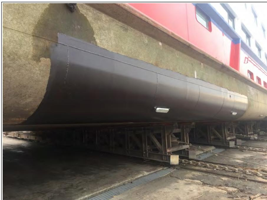
**Figure 21 : Structure externe réparée lors des travaux de novembre 2018**
