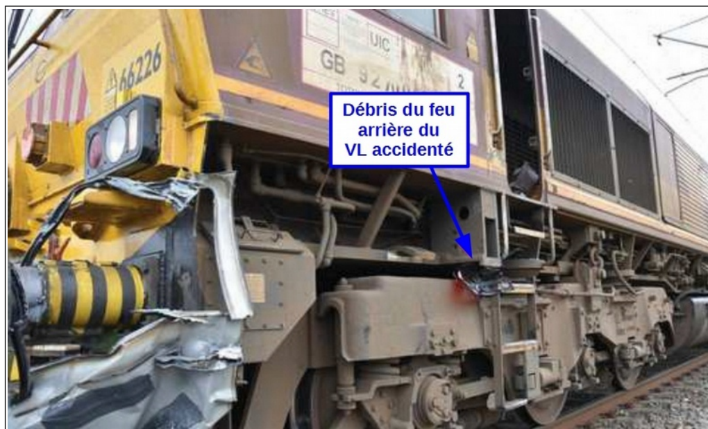
Figure 12 : Côté avant gauche de la locomotive
