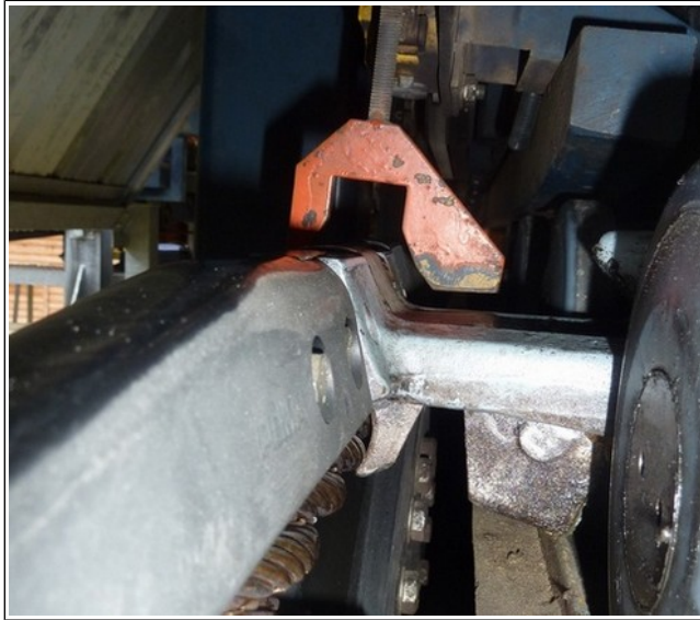
Figure 19 : la sécurité n° 1 en position normale avec un mors mobile embrayé
