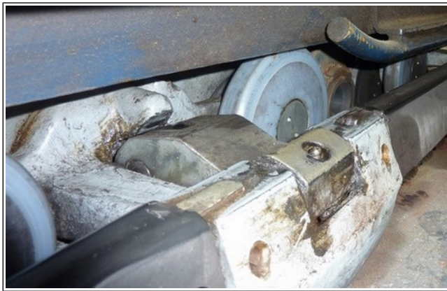
Figure 20 : le mors mobile en position non embrayée qui déclenche la sécurité n° 1
