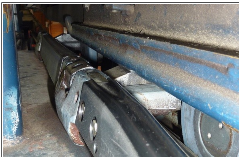
Figure 37 : rail d'abaissement en train de forcer sur le mors mobile pour le fermer
