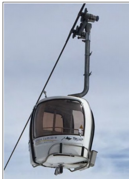
Figure 11 : cabine avec suspente et attache
