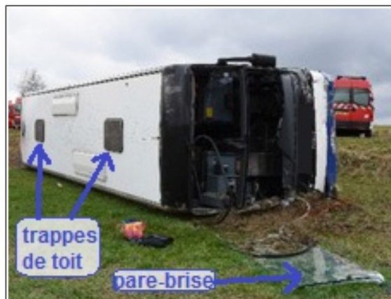
Figure 16 : trappes de toit
