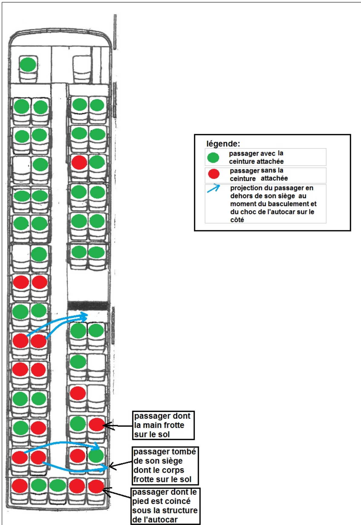
Figure 22 : répartition des passagers dans l'autocar, établie à partir des PV d'audition
