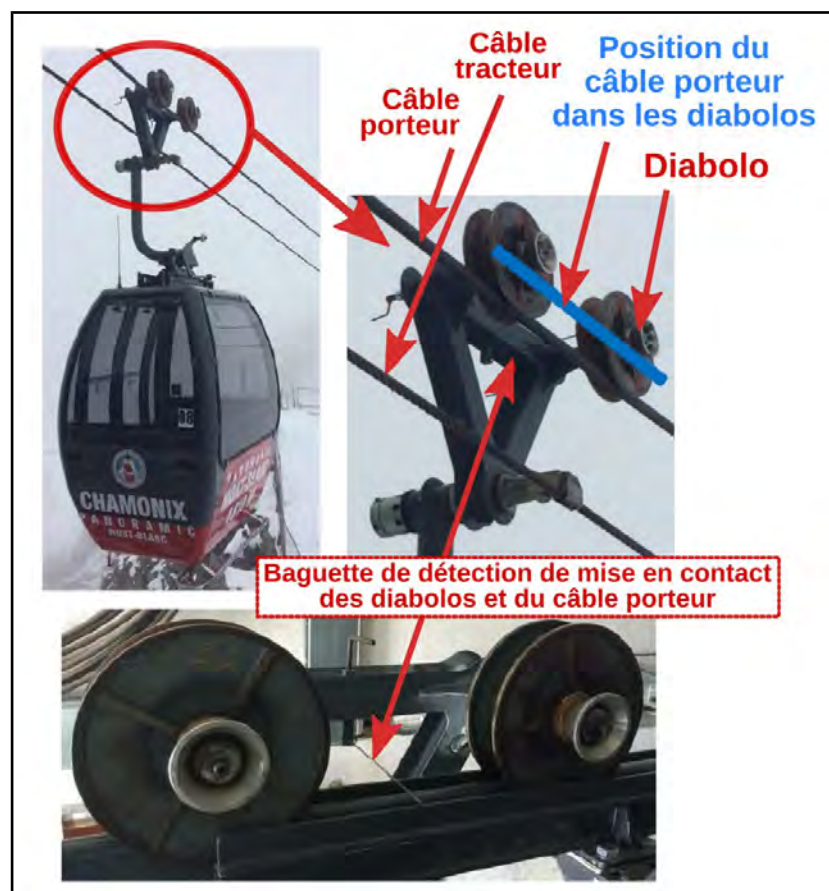
Figure 27 : dispositif de sécurisation et de détection du déraillement des chariots
