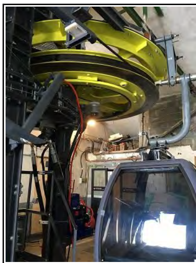
Figure 9 : vue de la poulie de retournement en gare de la Pointe Helbronner
