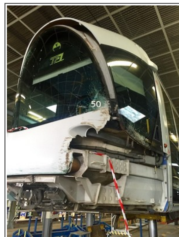
Fig. 12 : Dégâts occasionnés après le déraillement sur l'avant gauche de la cabine
