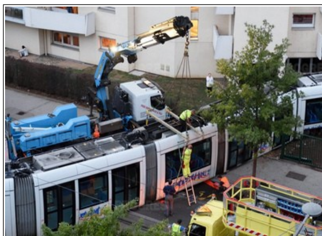
Fig. 23 : Les opérations de relevage de la rame
