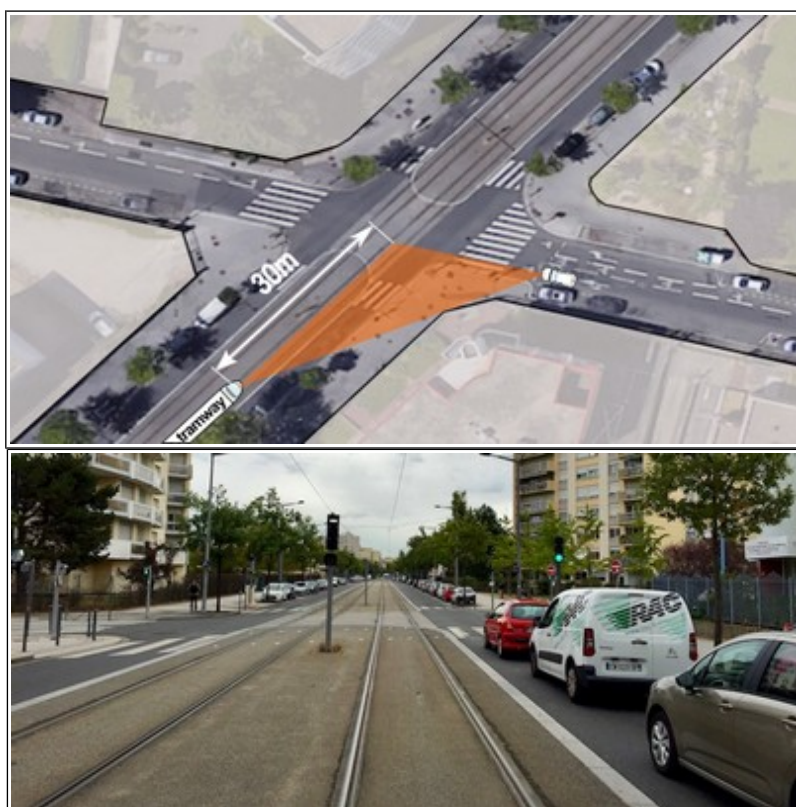
Fig. 7 : Triangle de visibilité réciproque et vision du conducteur de la rame à une trentaine de mètres du carrefour
