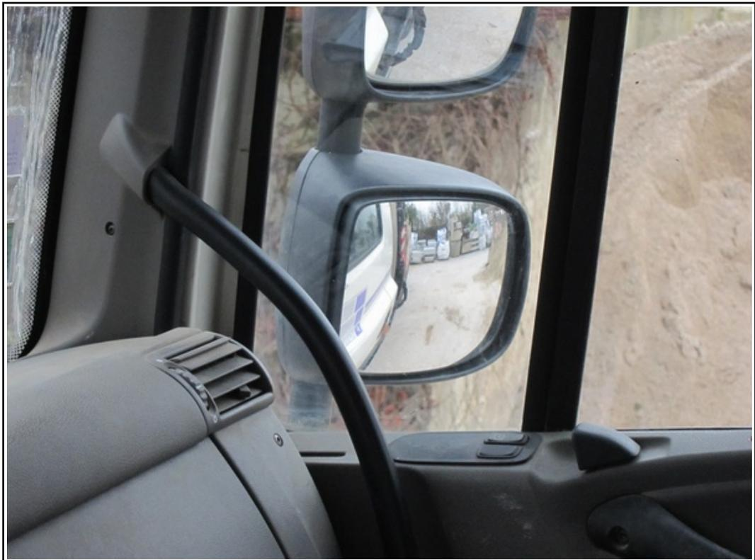
*Figure 13 : Rétroviseur « grand angle » du véhicule (A) côté passager avec champ de vision au sol*
