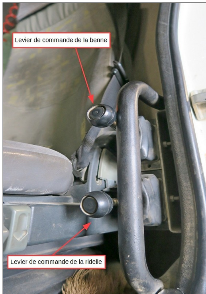
Figure 14 : Leviers de commande de la benne et de la ridelle
