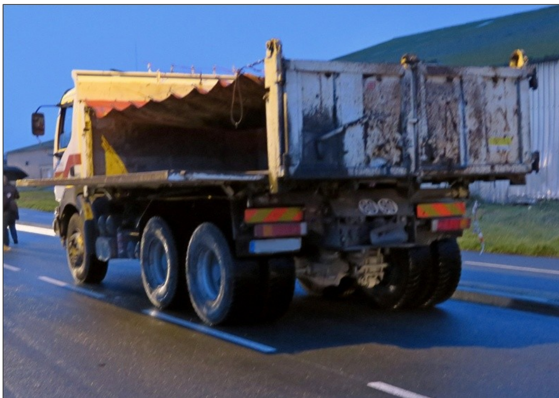
Figure 34 : Ridelle gauche qui empiète sur la voie opposée
