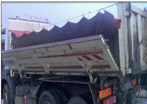
Figure 18 : Séquence d'ouverture de la ridelle jusqu'à un angle proche de 90°
