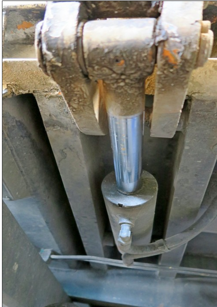
Figure 10 : Un des deux vérins principaux de la ridelle permettant son ouverture/fermeture
