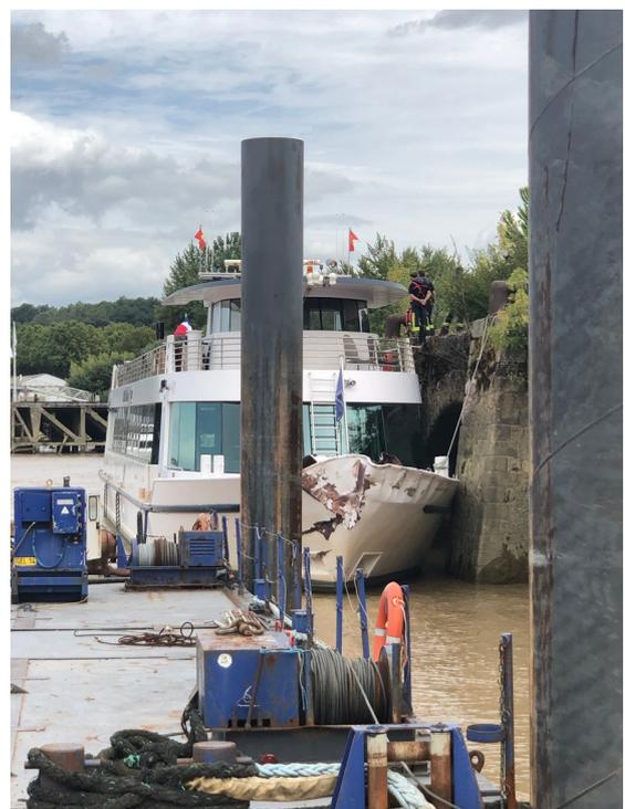
Les structures avant du bateau ont été enfoncées tout en présentant sur le côté tribord une rayure profonde avec déchirement de la tôle. Sur bâbord arrière, les tôles au niveau des œuvres mortes ont été légèrement déformées.
