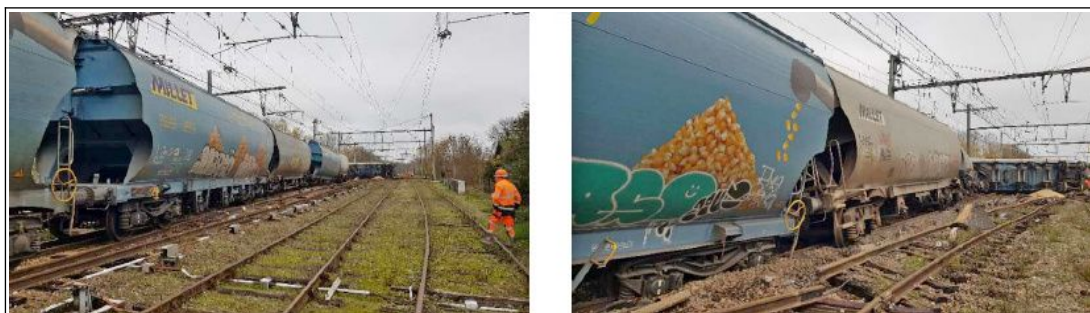
Figure 16 : Déraillement sur VS (Source SNCF Réseau)
