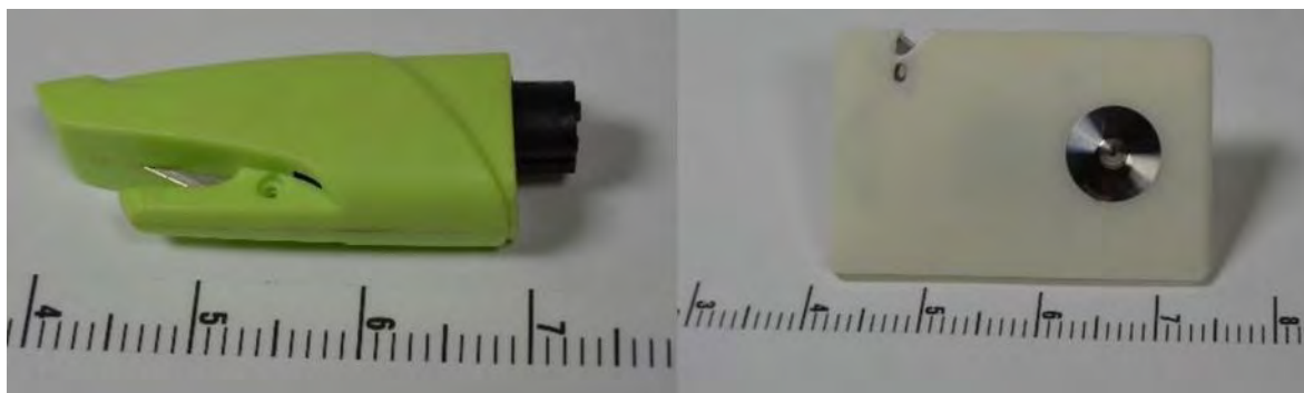
Figure 6 : Deux des outils testés par l'AAA ; à gauche un outil de type poinçon à ressort ; à droite l'outil de type plaque souple dotée d'un poinçon [AAA, 2019]
