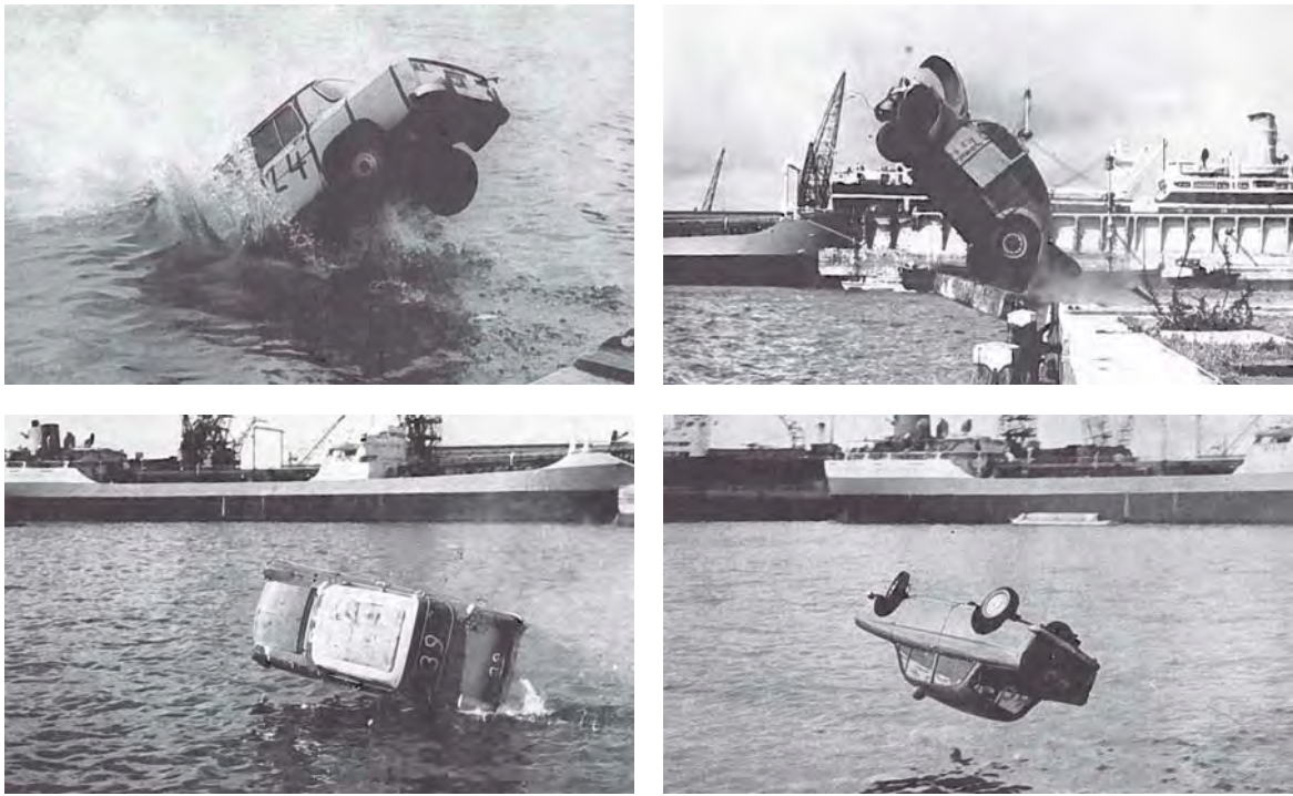
Figure 1 : Plusieurs exemples d'essais d'immersion réalisés par le SWOV ; en haut à droite, l'orientation du véhicule résulte d'une collision avec un obstacle Source [SWOV, 1973]
