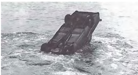
Figure 2 : Ce véhicule a touché l'eau sur le toit (à gauche) puis s'est retourné en position « normale » (à droite) avant de couler Source [SWOV, 1973]
