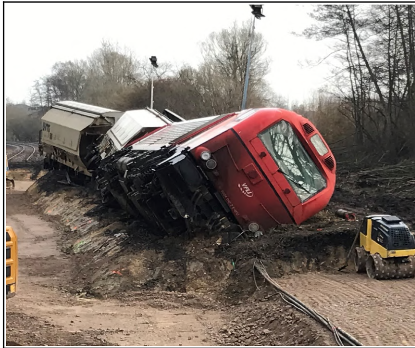
Figure 16 : Dégâts sur le train Fret CAPTRAIN ; engin moteur, et les 2 premiers wagons Photo BEA-TT
