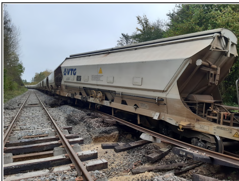
Figure 14 : Dégâts sur le train Fret Captrain engin moteur, et les 2 premiers wagons Photo BEA-TT
