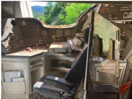
Dégâts cabine de conduite et 1 ère élément de la rame
