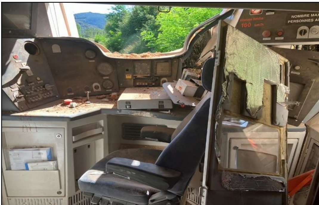
Figure 16 : Dégâts dans la cabine de conduite Source gendarmerie
