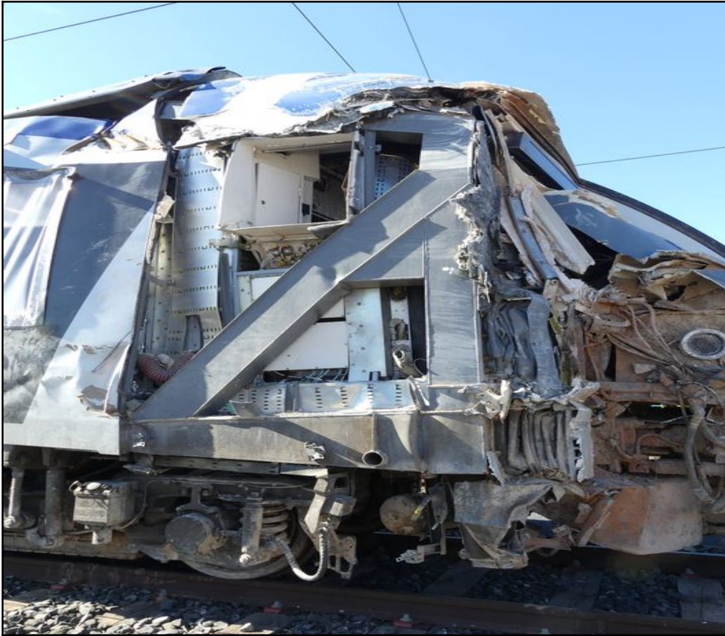
Figure 15 : Dégâts de l'avant de la rame TER et vue d'une partie des structures amortissantes Source BEA-TT
