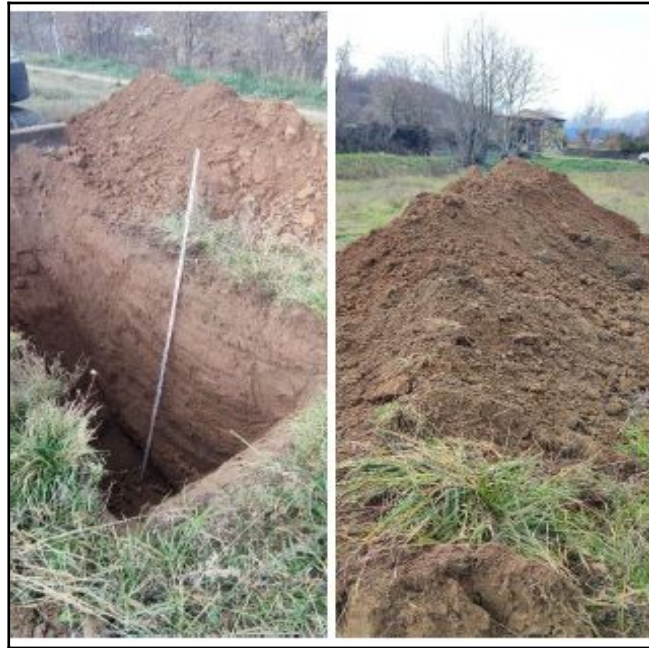
Figure 35 : Vue des forages du terrain et des matériaux extraits au-dessus de la voie ferrée.
