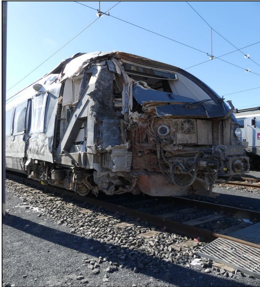
Figure 14 : Dégâts de la rame TER, vue sur la motrice avant Source SNCF
