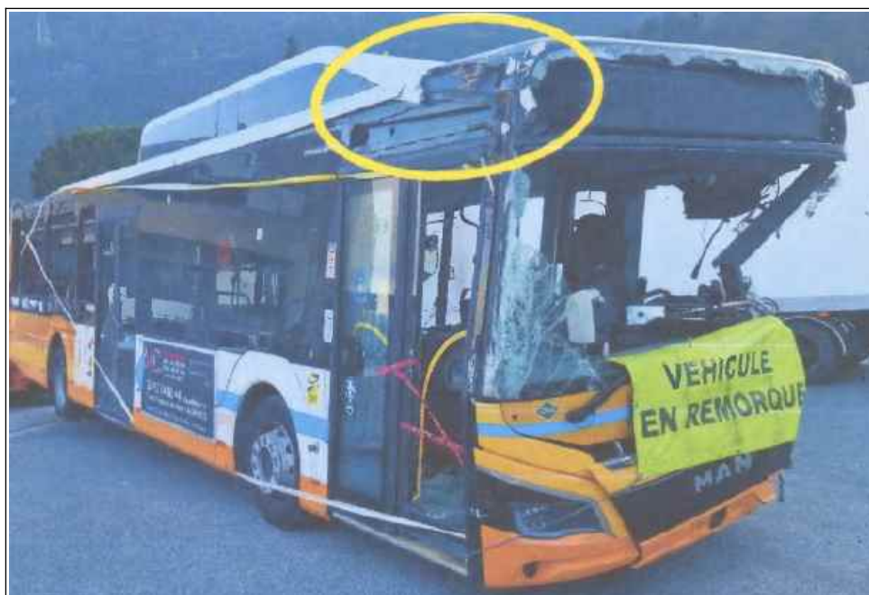
Figure 11 : Avant du bus avec localisation de la partie qui a heurté la paroi rocheuse source : expert judiciaire
