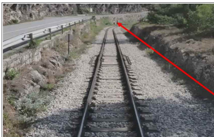
Figure 8 : Extrait du film du simulateur de conduite de l'exploitant qui donne une indication sur la position du train à partir de laquelle le conducteur peut voir le bus immobilisé dans le virage et actionner le freinage d'urgence (sens Digne/Nice avec zone de vitesse maximale 50 km/h)
