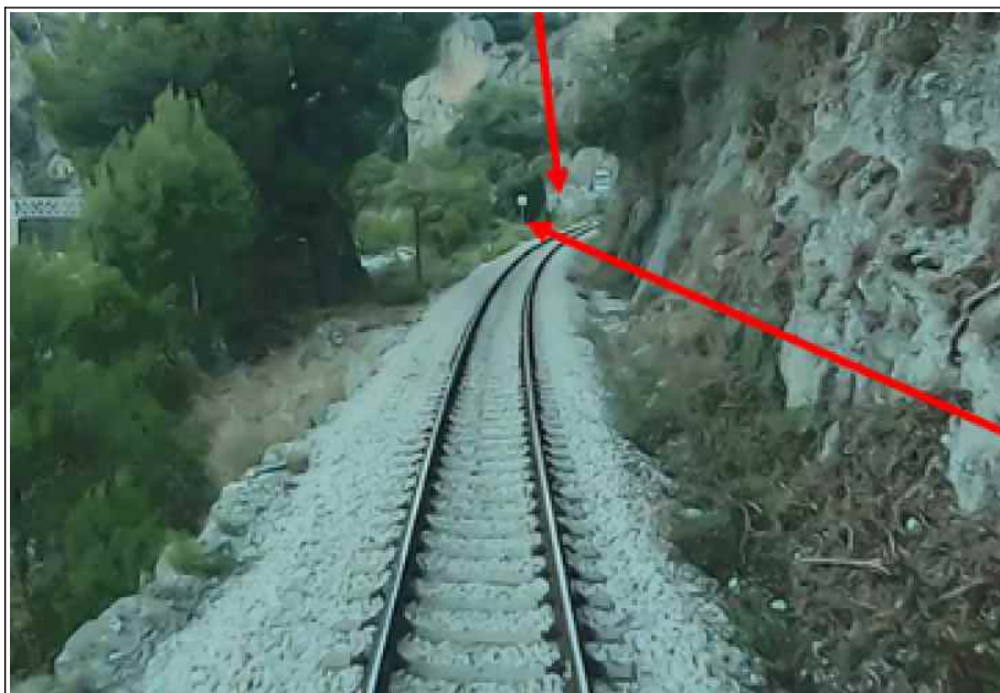
Figure 7 : Extrait du film du simulateur de conduite de l'exploitant qui donne une indication de la vue depuis la cabine du conducteur du train dans le sens Nice/Digne sachant que le bus s'est immobilisé entre les 2 panneaux de signalisation (« 50 » et « GARE ») indiqués par les flèches rouges
