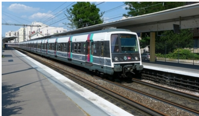
Rame MI 79 rénovée en gare de Bourg-la-Reine
