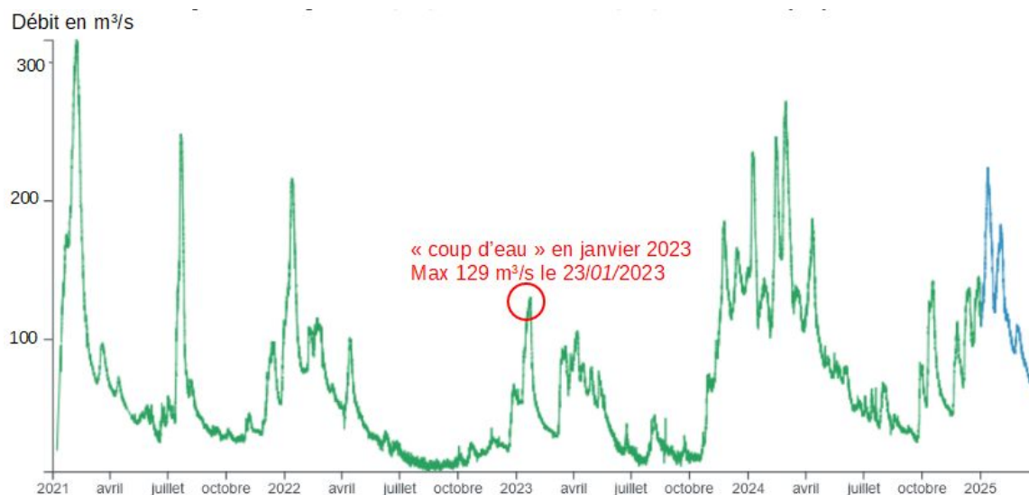
Figure 28 : Débit instantané (m 3 /s) à Soissons, janvier 2021 - mars 2025 (Source : Hydroportail)
