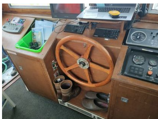
Figure 33 : Équipements de navigation et commandes de la gouverne présents en timonerie (source : BEA-TT)
