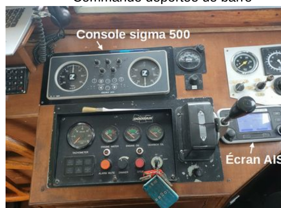
Figure 33 : Équipements de navigation et commandes de la gouverne présents en timonerie (source : BEA-TT)
