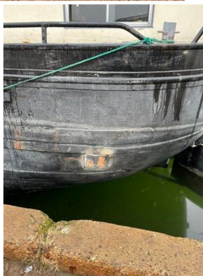
Figure 35 : Brèche ouverte (d'environ 100 × 50 mm) à l'arrière bâbord et refermée par soudure, vues prises sur le site de Vailly-sur-Aisne et après déchargement du bateau (source : expert de l'assurance)
