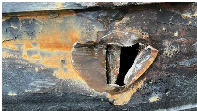
Figure 35 : Brèche ouverte (d'environ 100 × 50 mm) à l'arrière bâbord et refermée par soudure, vues prises sur le site de Vailly-sur-Aisne et après déchargement du bateau (source : expert de l'assurance)
