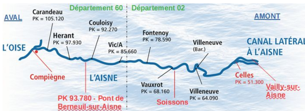
Figure 6 : Linéaire de l'Aisne canalisée avec ses 7 barrages – écluses (source : VNF, avis à la batellerie n° 1 – 2020, retouché BEA-TT)
