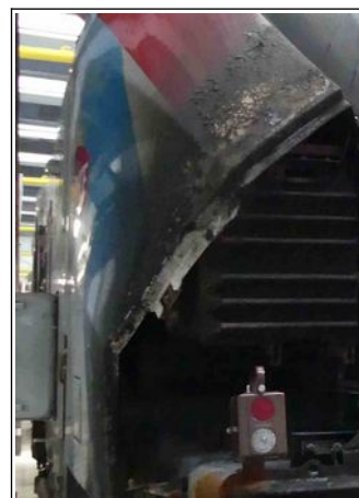
Dégâts des incendies sur les éléments de carrosserie
