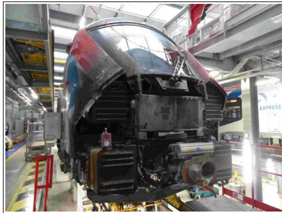
Figure 21 : vue de la motrice de tête après l'accident photo BEA-TT
