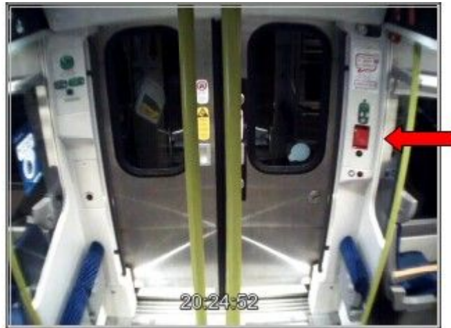
Figure 32 : illustration de l'ouverture de secours des portes (levier rouge) image SNCF V
