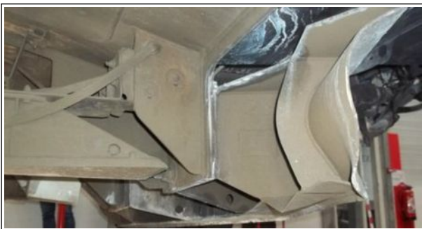
Impacts sur le chasse-obstacles sous la caisse
