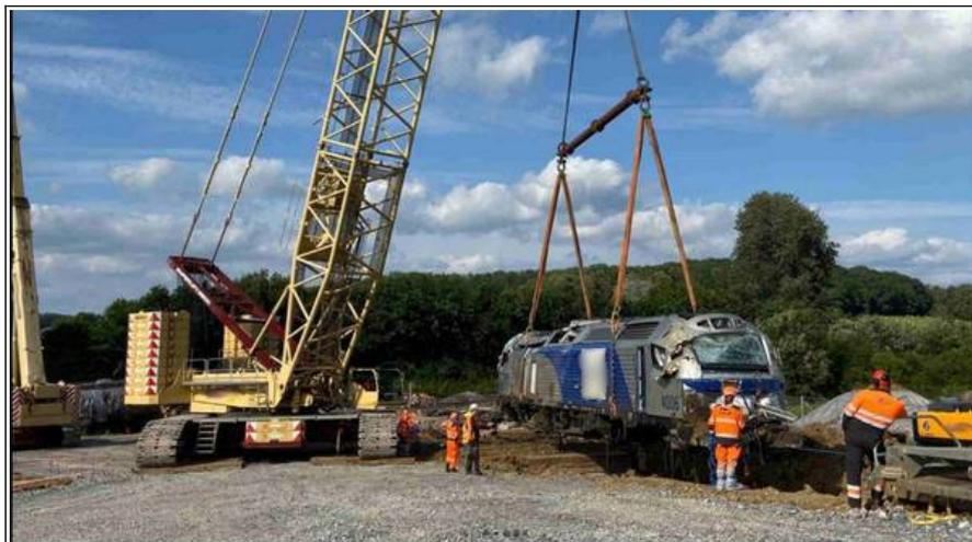
**Figure 45 : opérations spécifiques de relevage de la motrice**
