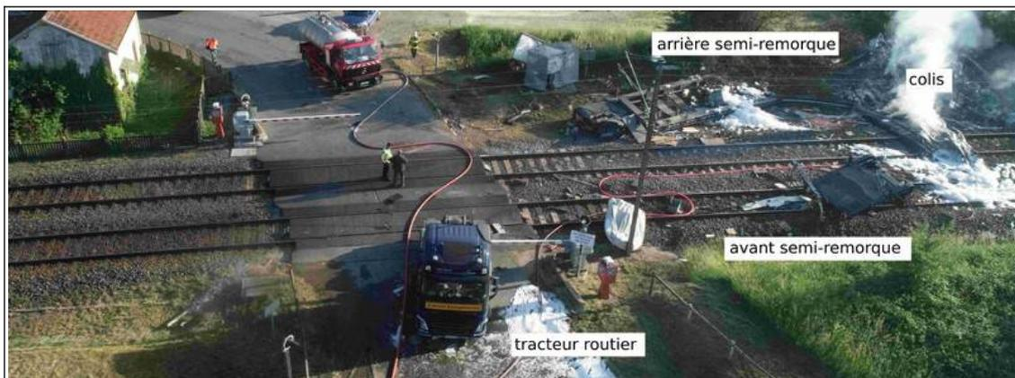
**Figure 33 : vue d'ensemble du convoi routier après la collision**
