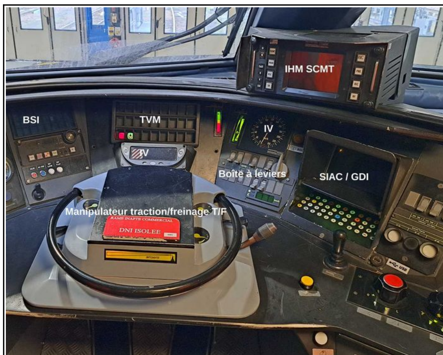
Figura 13: in dettaglio il pannello di comando della motrice 380005 (foto BEA-TT)
