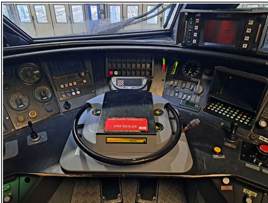
Figura 12: visione d'insieme del pannello di comando della motrice 380005 (foto BEA-TT)
