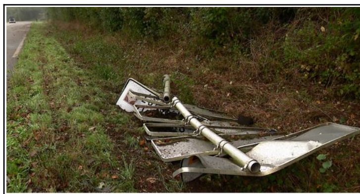
Figure 34 : Poteau percuté et sectionné (photo Gendarmerie nationale)
