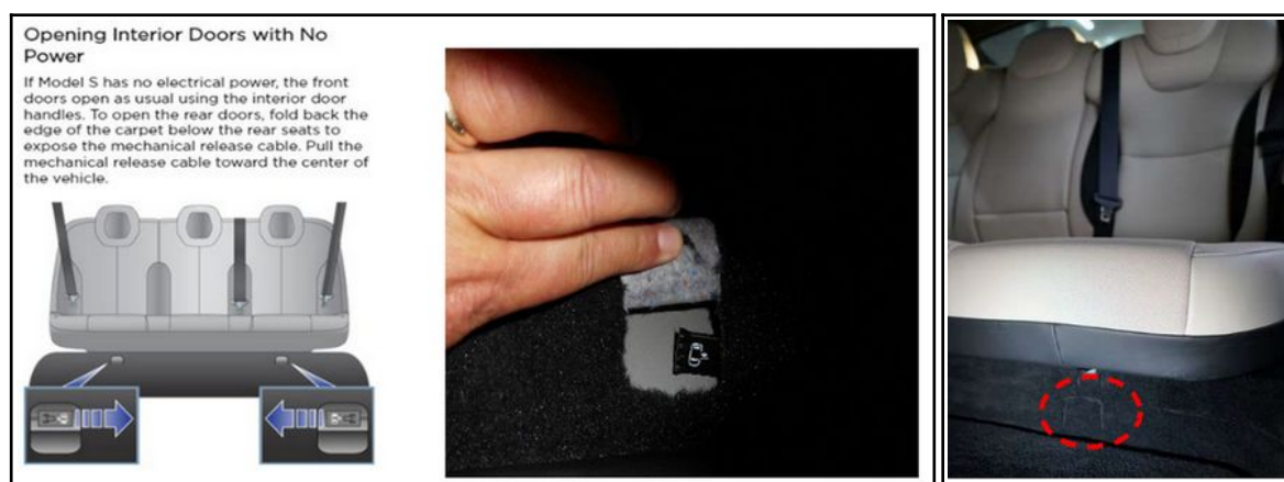
Figure 42 : Système d'ouverture de la portière arrière gauche d'une Tesla model S P100D et Plaid (photos de gauche NTSB et de droite expertise judiciaire)
