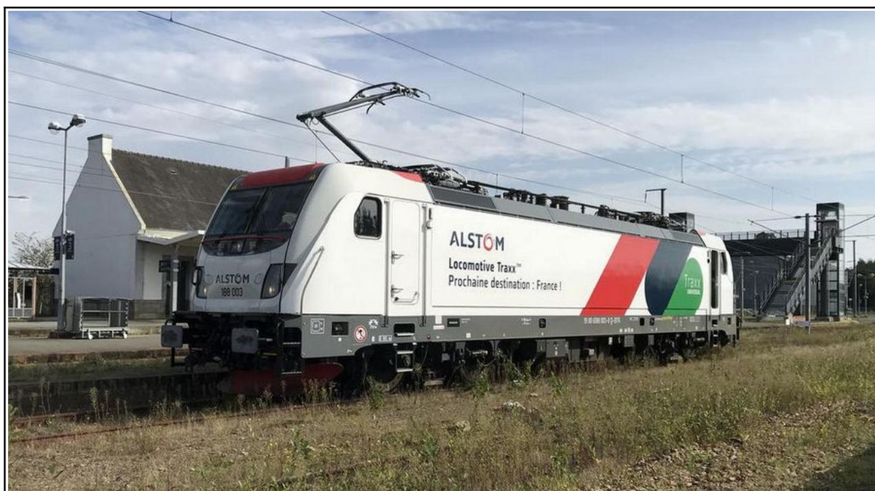
*Figure 4 : la locomotive TRAXX MS 3 n° 188 003 d'Alstom*
