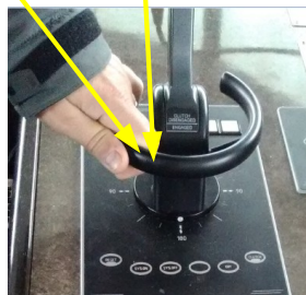
Fig 3 Gouverne de directive manuelle des PODS
