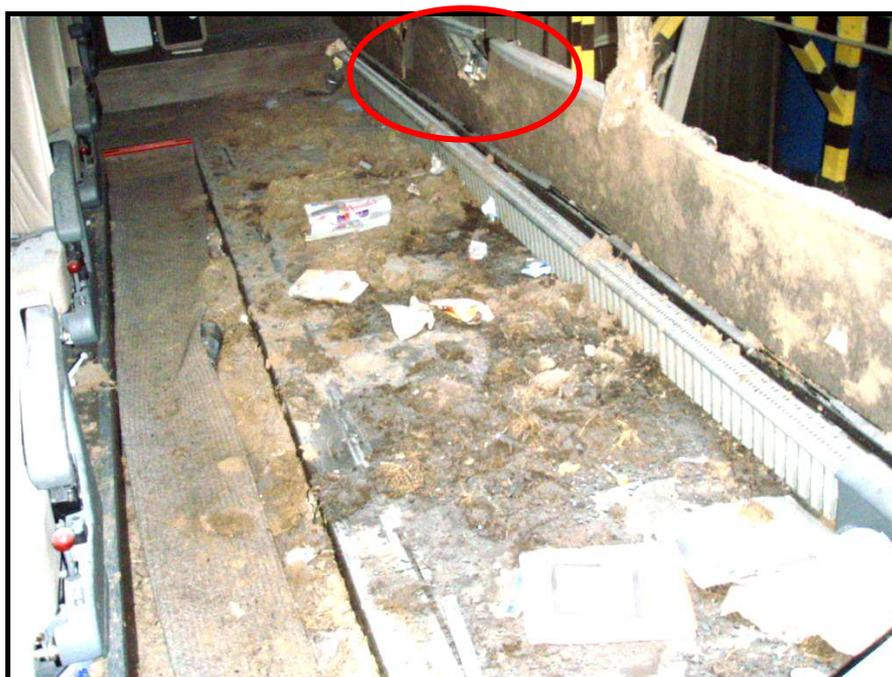
L'intérieur de l'autocar, et particulièrement le plancher gauche, est maculé de terre et de débris.
