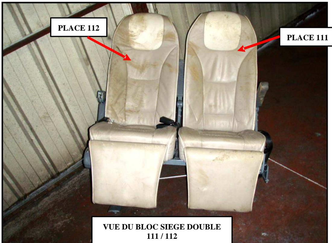
Nous ne relevons aucune trace de fléchissement ni de déformation notable des embases et des ferrures :
