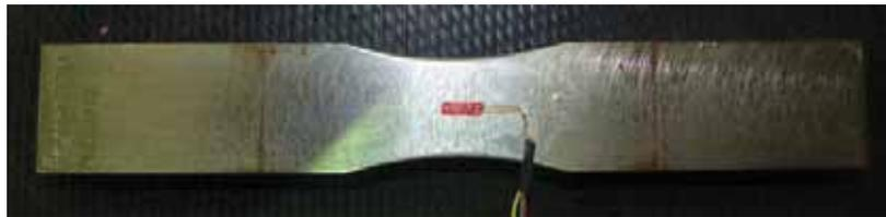
**Photo 3** : éprouvette instrumentée
