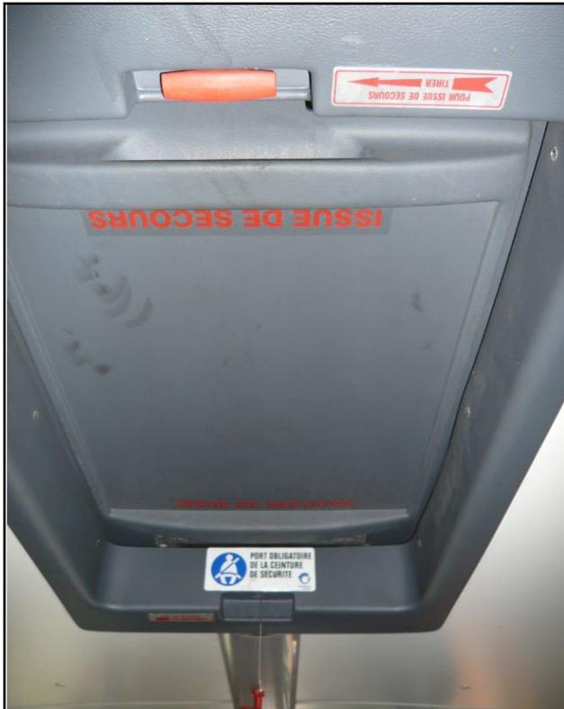
**Figure 29 : Une des deux trappes de toit avec son signalement comme issue de secours et ses deux poignées de déverrouillage, de couleur rouge**
