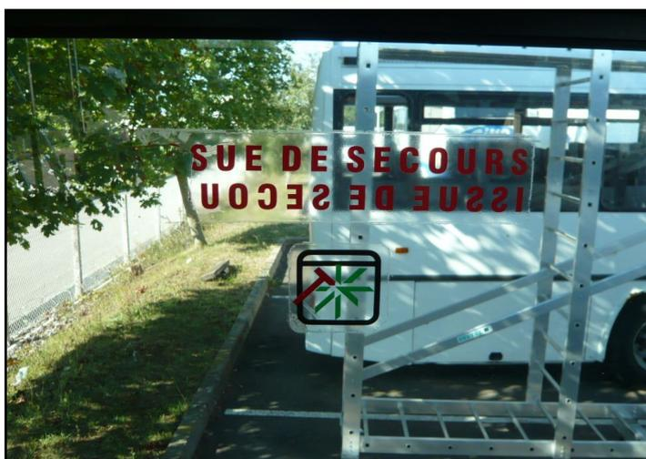
**Figure 27 : Une issue de secours, avec le signalement de son emplacement et du point où il faut taper pour briser la vitre**
