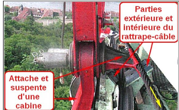
2 - Vue du passage d'une cabine avec le câble tracteur soulevé au-dessus des galets
