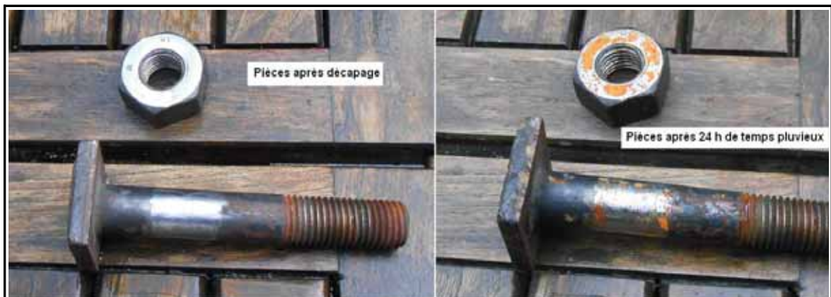
Figure 42 : Effet de la pluie sur des pièces de boulonnerie décapées
