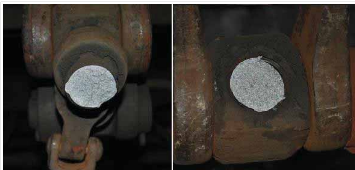
Figure 13 : Vues des surfaces de rupture de la vis du tendeur
