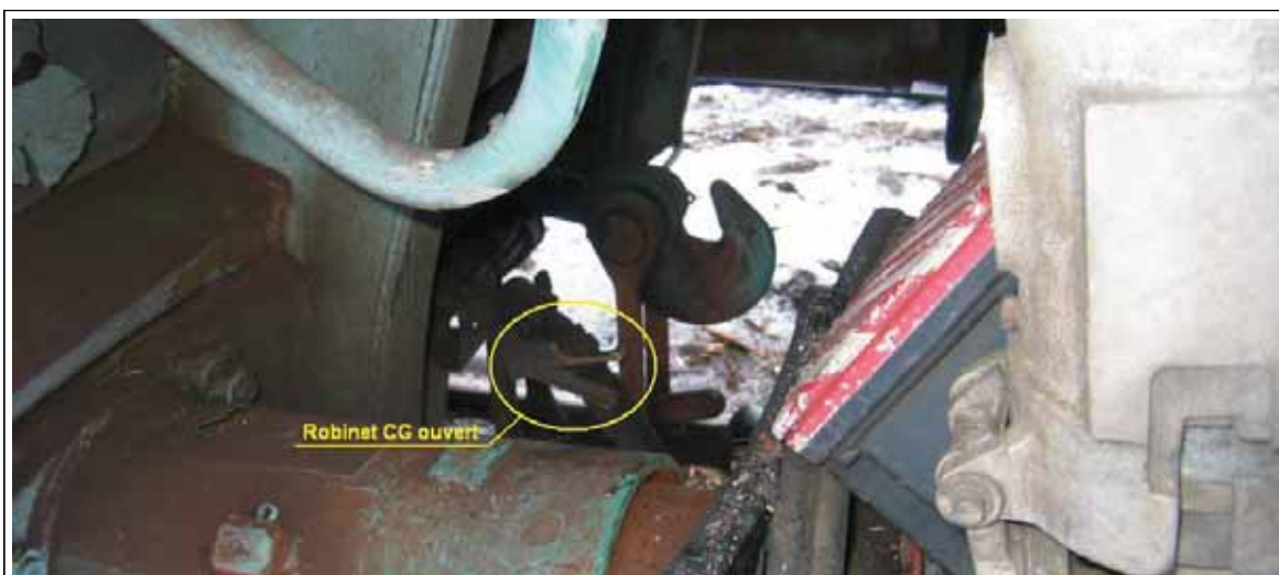
Figure 19 : Arrière du wagon avec robinet CG ouvert.
