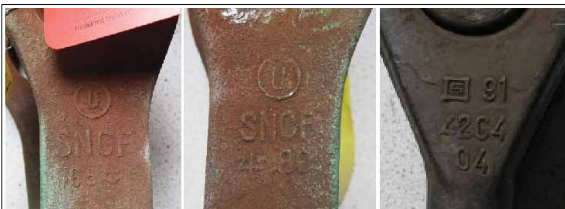
Figure 12 : Marquages des bielles et de la manille
