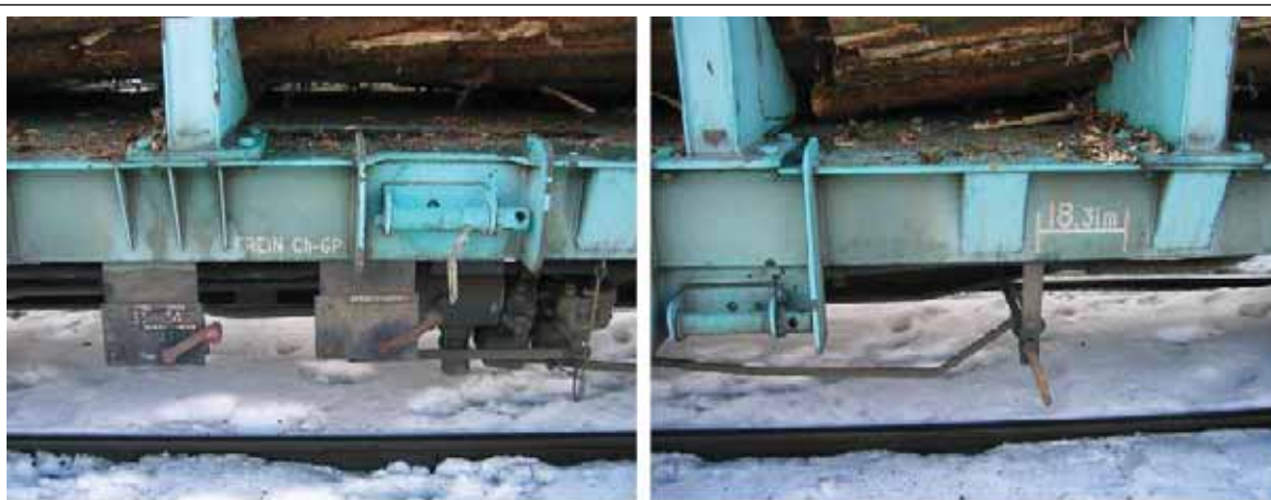
Figure 3 : Position des manettes sur le wagon
