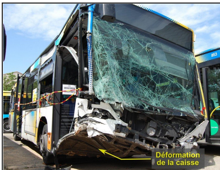
Figure 16 : Traces du choc avec le talus
