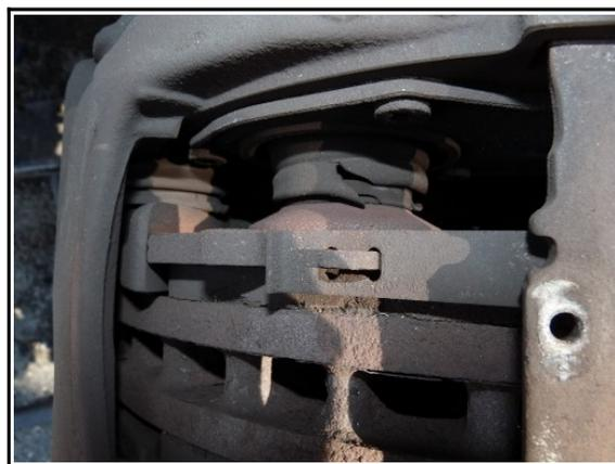
Figure 17 : Vue d'une protection de piston de frein déchirée du tracteur de l'ensemble routier (A)
