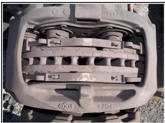
Figure 16 : Vue d'un étrier de frein oxydé du tracteur de l'ensemble routier (A)
