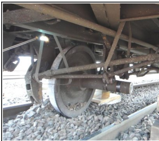
Figure 12 : Le demi-essieu resté sous le wagon
