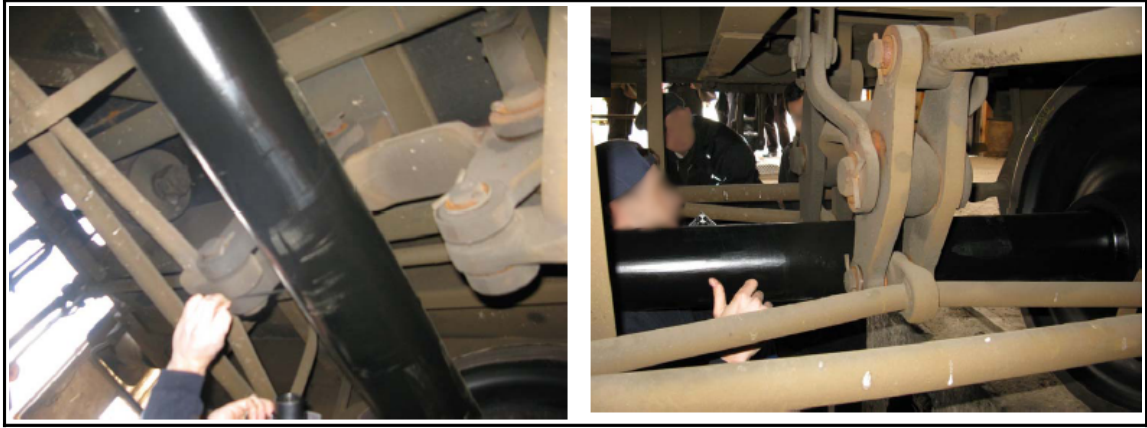
Figure 17 : Examen de la timonerie d'un wagon Laaips
