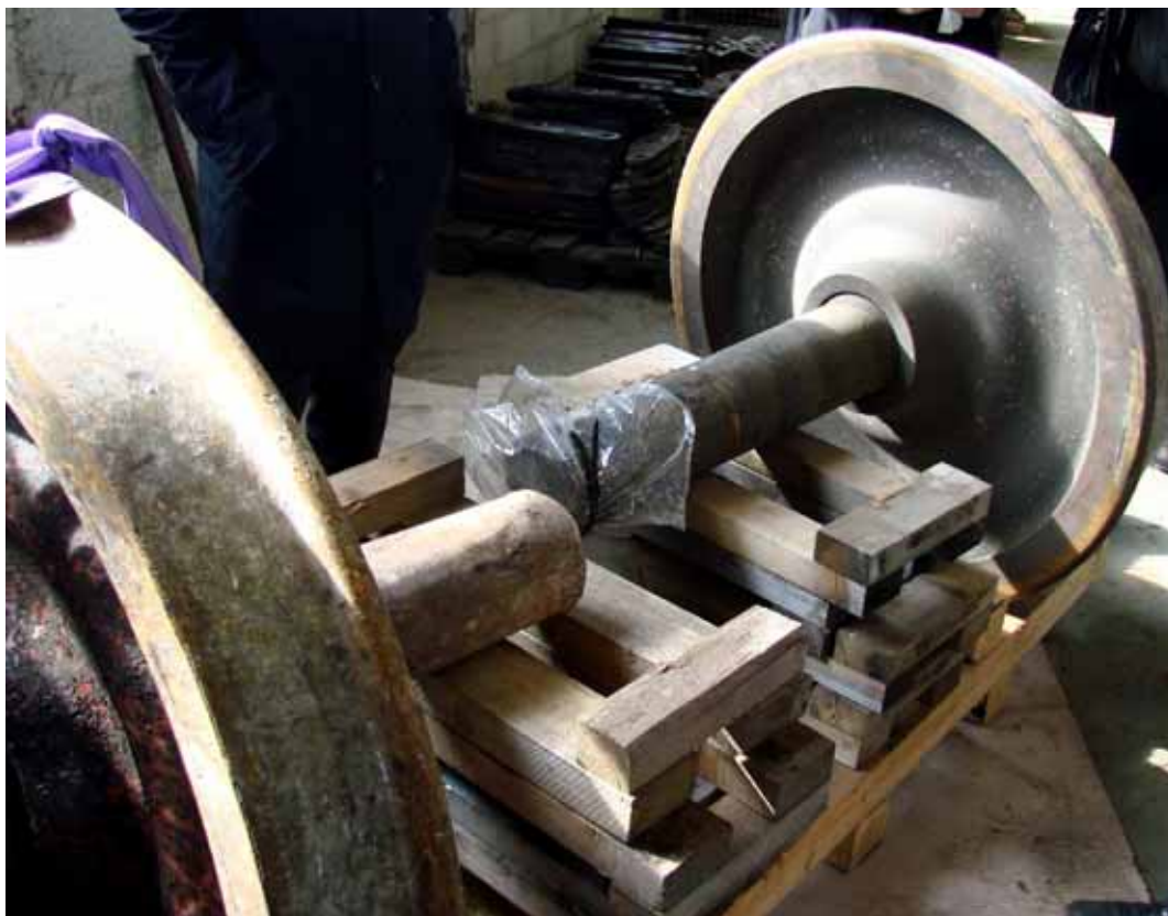
Photo 1 : vue générale de la rupture de l'essieu.
