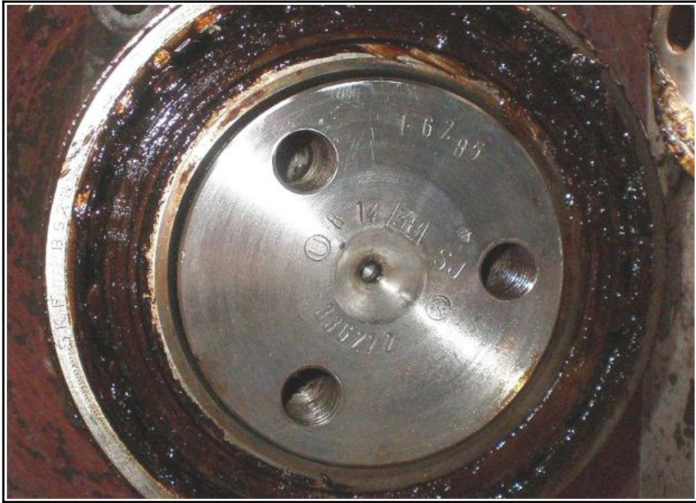
Figure 13 : Marquages de l'axe de l'essieu rompu
