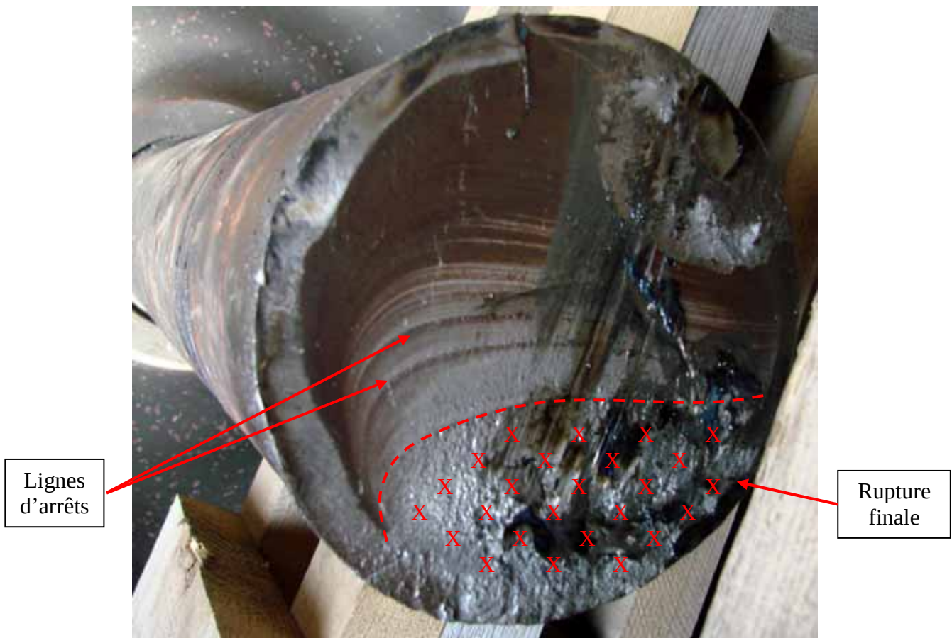
Photo 4 : faciès de rupture.
