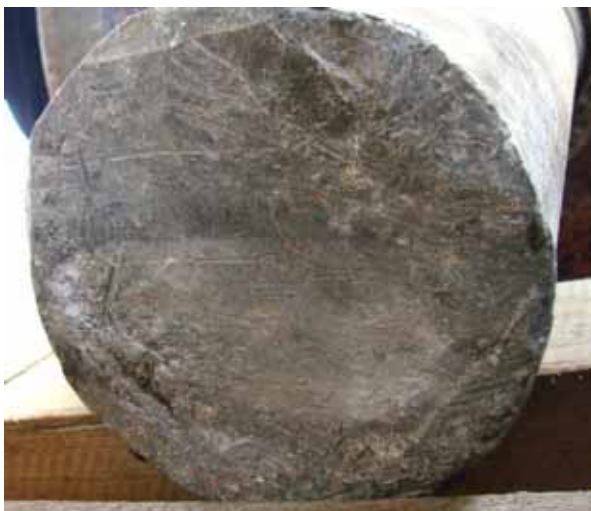
Photo 1 : vue de la rupture de l'essieu côté droit.
