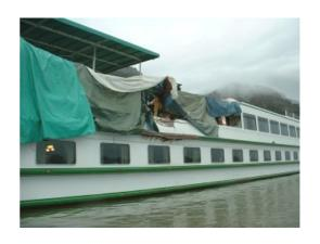
Le 28 mars 2006 à 02h28, le bateau à passagers CAMARGUE, avec à son bord 138 passagers et 25 membres d'équipage, a heurté une pile du viaduc ferroviaire de la-Voulte-sur-Rhône lors de sa manoeuvre du passage du pont. Le choc a causé d'importants dégâts aux superstructures du bateau. Neuf passagers ont été légèrement blessés. Le pont n'a pas subi de dégâts notables et l'accident n'a pas eu d'incidence sur la navigation.
