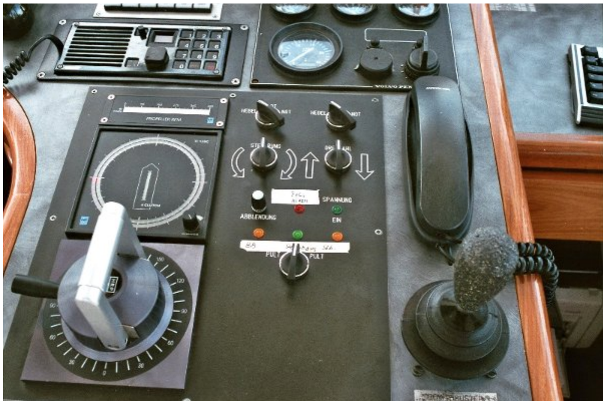
Pupitre central timonerie Commande des propulseurs
