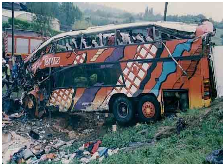
Figure 10 : vue des déformations de l'autocar après son redressement
