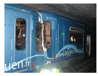
La ligne du tramway de Rouen comporte une partie souterraine, munie de feux de cantonnement, dont la configuration s'apparente à celle d'un métro. Le matin du 30 août 2004, une rame de tramway franchit indûment un feu de cantonnement fermé et vient percuter l'arrière de la rame arrêté devant elle dans le tunnel.
