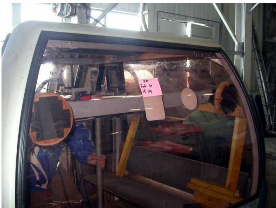
Le déboîtement des vitrages étant plus facilement réalisés en exerçant des efforts dans les angles (tests « C »), les essais « A » ont été abandonnés en cours d'essais. Les tests « B » ont également été abandonnés: un coefficient correcteur permettra, dans le rapport final, d'intégrer la cause aggravante représentée par la poussée simultanée d'un deuxième corps sur le même vitrage.
