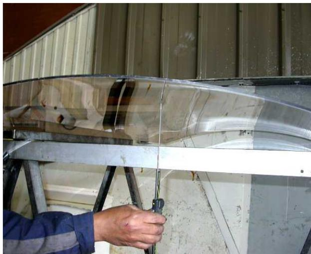
*Installation du dynamomètre pour un essai d'effort statique de catégorie « A » sur « Piccolo »*
