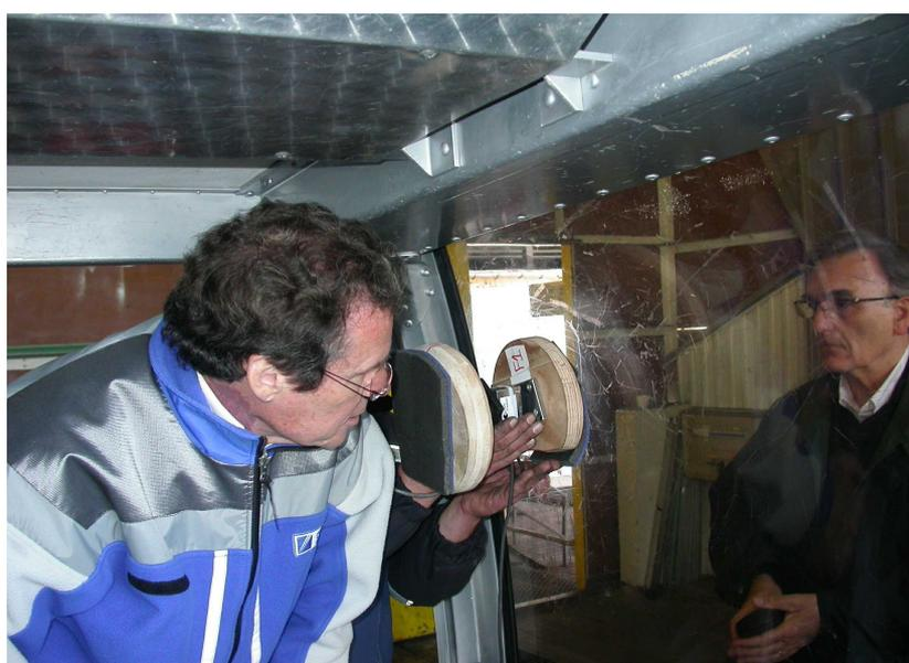
Le coup d'épaule simulant, donc, un choc sur vitrage consécutivement à un déséquilibre à l'intérieur d'une cabine, a été testé sur des valeurs comprises entre 40 et 160 da N. Au delà de 100 à 110 da N, on peut considérer qu'il ne s'agit plus d'un effort d'impact (dynamique) accidentel.
