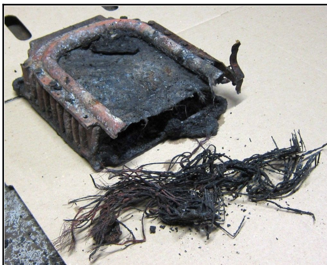
Figure 13 : Vue du calculateur moteur de l'autocar après l'accident
