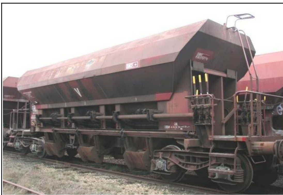
Figure 5 : Wagon de type Uas semblable aux wagons déraillés
