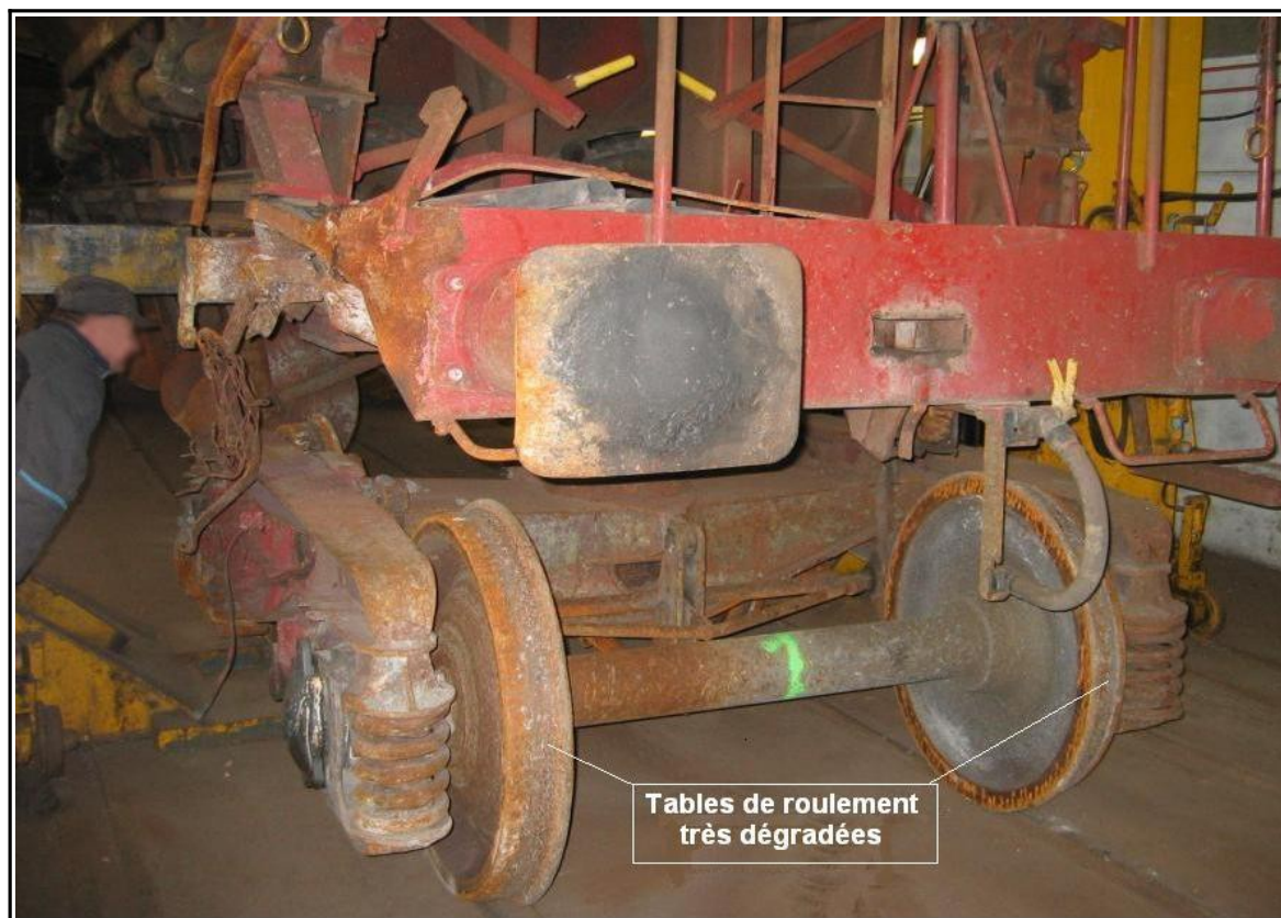
Figure 12 : Vue de l'essieu 7-8 du bogie 2 lors de l'expertise à Nîmes-Courbessac
