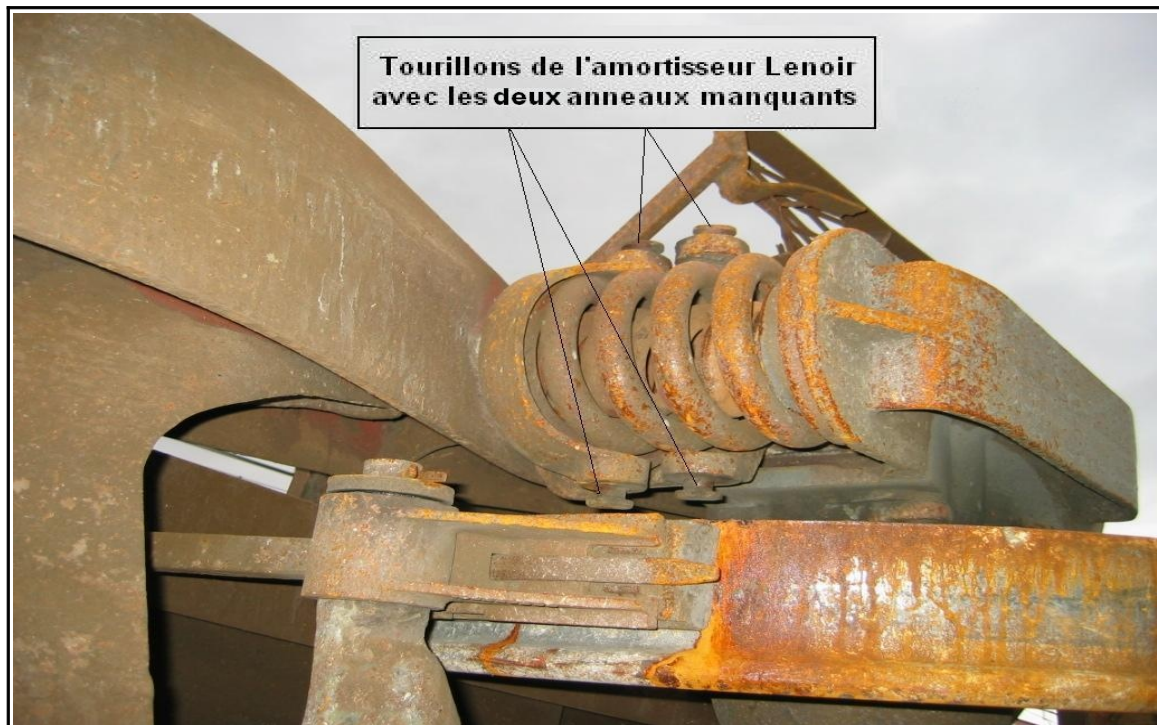
Figure 10 : Amortisseur Lenoir de la roue 2 du premier wagon couché
