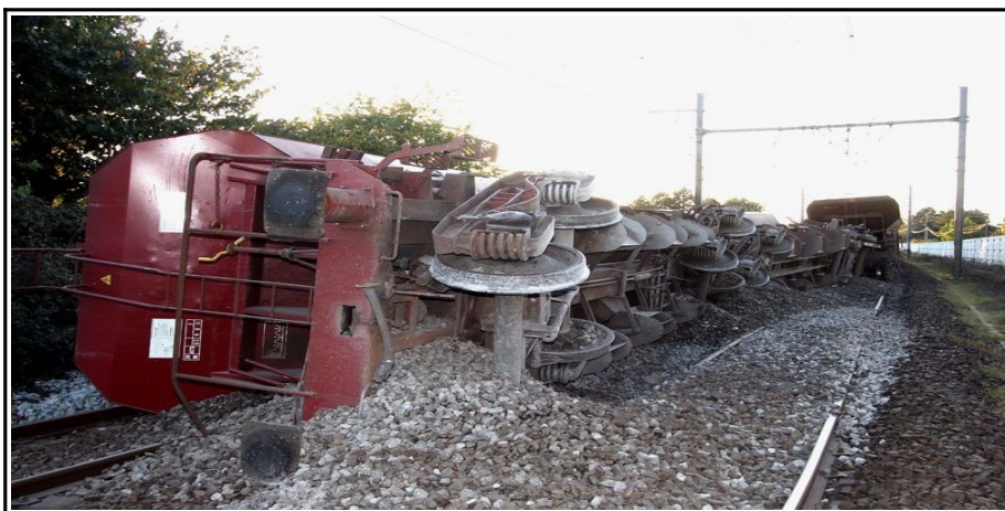
Figure 2 : Les deux wagons trémies couchés engageant la voie 2 et le troisième wagon déraillé, non couché.
