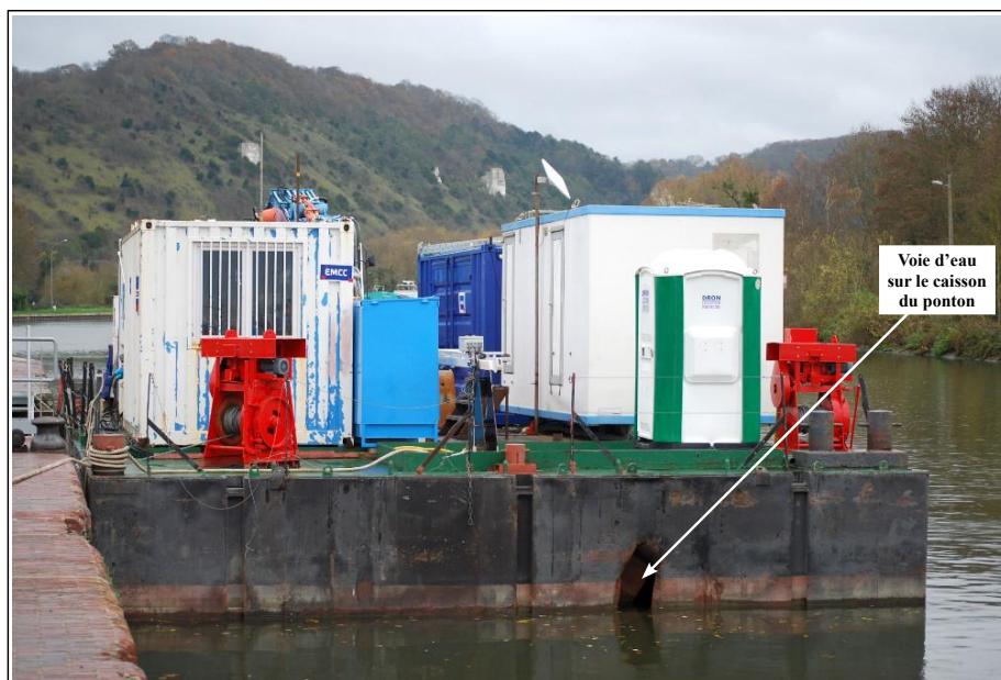
Figure 21 : Vue du ponton ANGLORE, à quai en amont des écluses, fin novembre 2011
