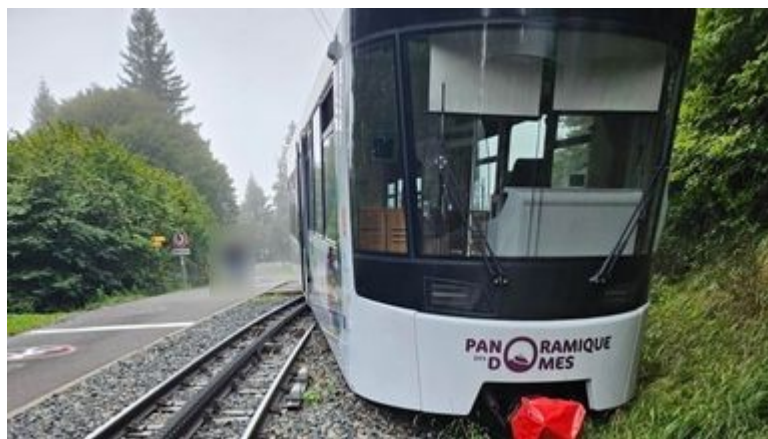
Position finale de la rame n°3 après son déraillement (source TC Dômes)
