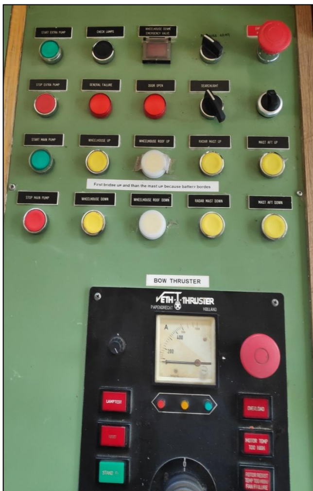
Pupitre de commande de levée et descente de la timonerie
