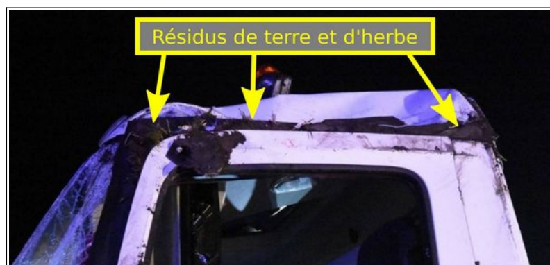
Figure 8 : Vue du côté gauche de la cabine du PL accidenté après relevage Photographie Gendarmerie nationale légendée BEA-TT
