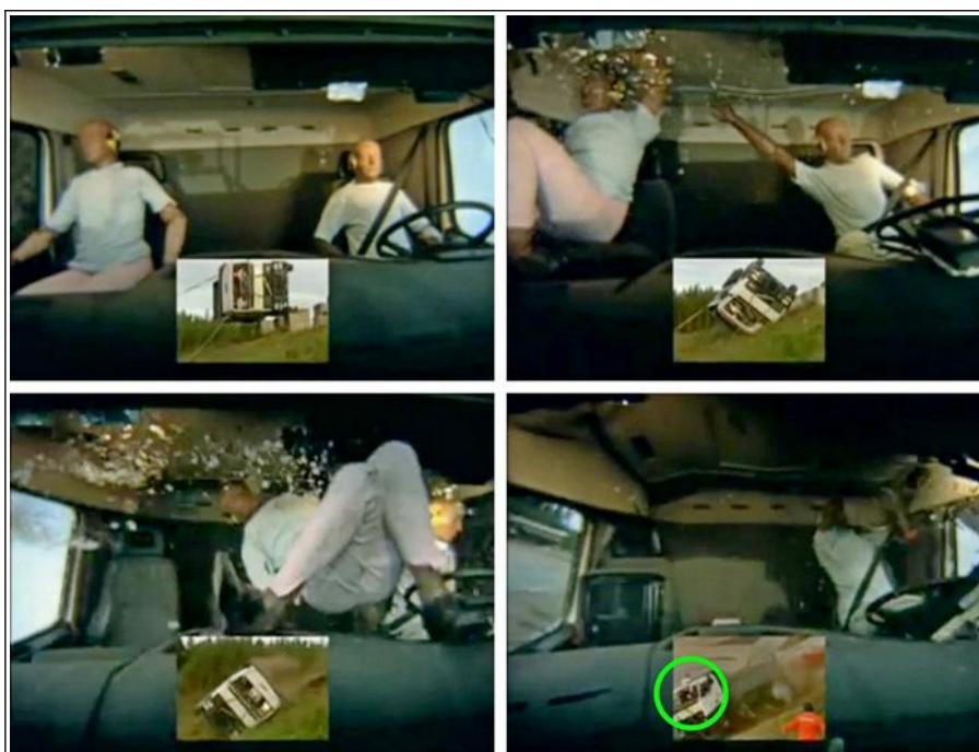
Figure 38 : Test de renversement d'un poids lourd avec des mannequins Source Volvo Trucks
